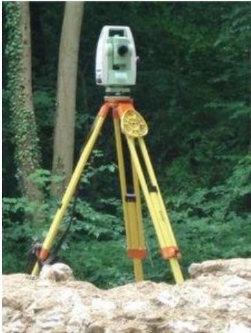
Le **tachéomètre** est un théodolite, mesurant en plus les distances.
